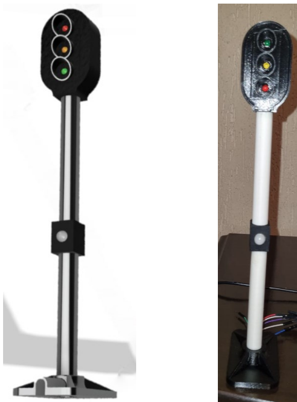
Figura 1 – Modelo e protótipo de um semáforo de pedestre com sensor de presença
