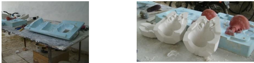
Figuras 14 (a e b) – Matriz (azul) para produção dos moldes em gesso.
