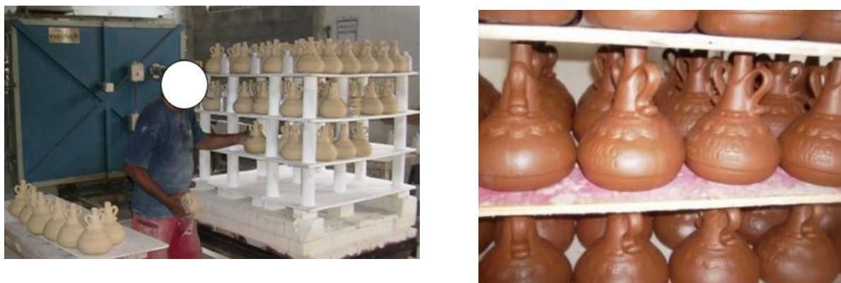
Figuras 17a e b – Processo de queima e tratamento térmico das peças cerâmicas em ambiente controlado.
