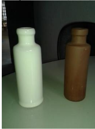
Figuras 18 – Acabamento com a utilização de esmalte (branca) e sem esmalte (terra cota).
