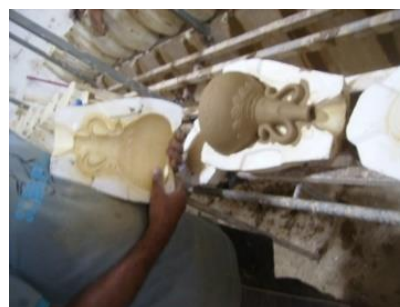
Figuras 16 – Desmoldagem – Retirada das peças do molde, após o processo de fundição.
